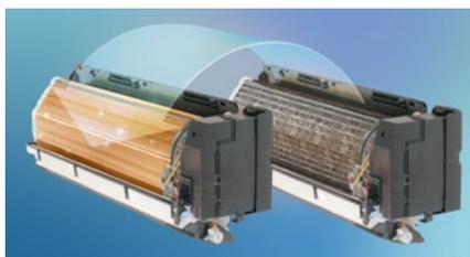
В режиме самоочистки теплообменник нагнетает влагу, потом замораживается и размораживается. Вследствие чего, отделяется весь мусор и грязь и с конденсатом удаляется через дренаж.
