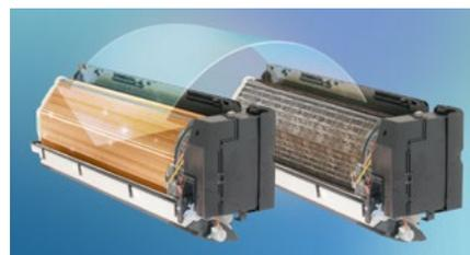
В режиме самоочистки теплообменник нагревается влагу, потом замораживается и размораживается. Вследствие чего, отделяется весь мусор и грязь и с конденсатом удаляется через дренаж.
