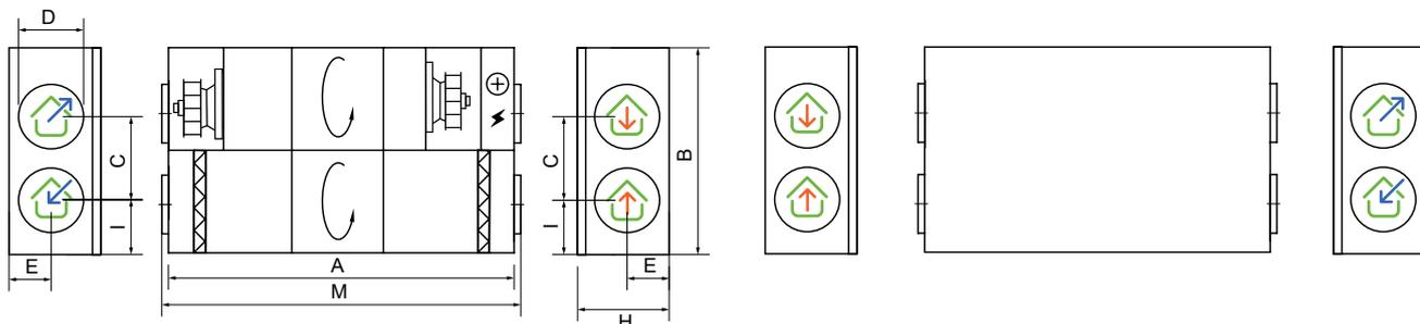
↻ - Наружный воздух; ↻ - Удаляемый воздух; ↻ - Вытяжной воздух из помещения; ↻ - Приточный воздух;
